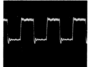
39 IC362 11 pin 7Vp-p, 0.5μs
